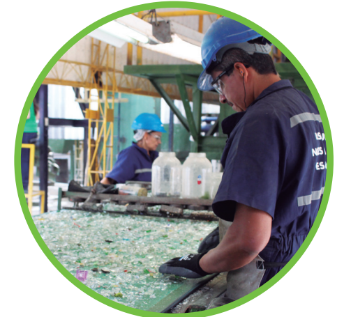
Extracción de contaminantes
