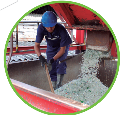
Tolva de despacho
